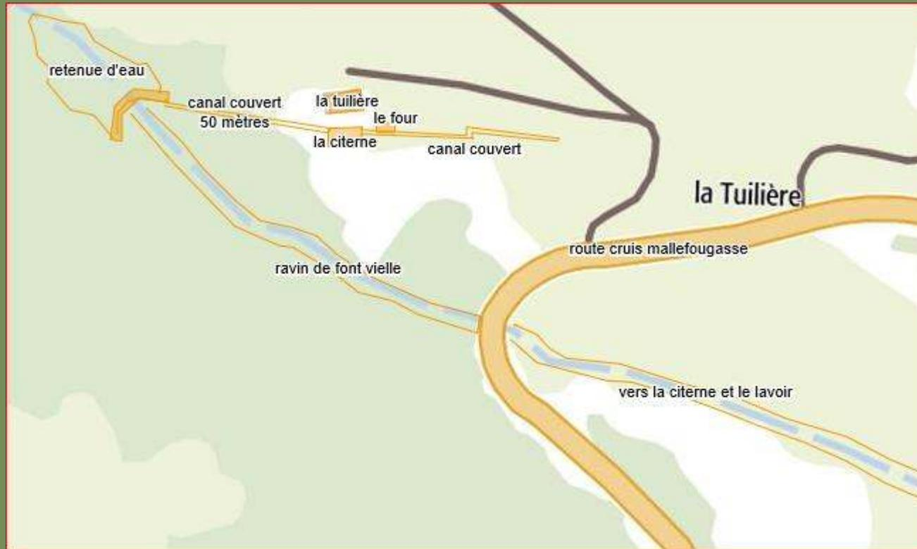
*Sur le haut du ravin de Font Vieille est construite une retenue d'eau qui alimente la citerne par un canal de 50 mètres environ. Il est couvert de pierres plates. Au niveau de la citerne une « tempe » dirige l'eau, soit vers la citerne, soit vers le canal en dessous. L'eau se déverse en arrosant les champs en contrebas vers le ravin et va alimenter le lavoir et sa citerne, principaux points d'eau du village.*
